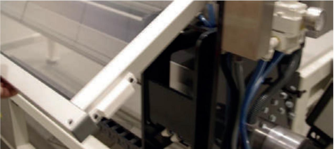
Afloje los dos tornillos con una llave Allen de 13 mm.
