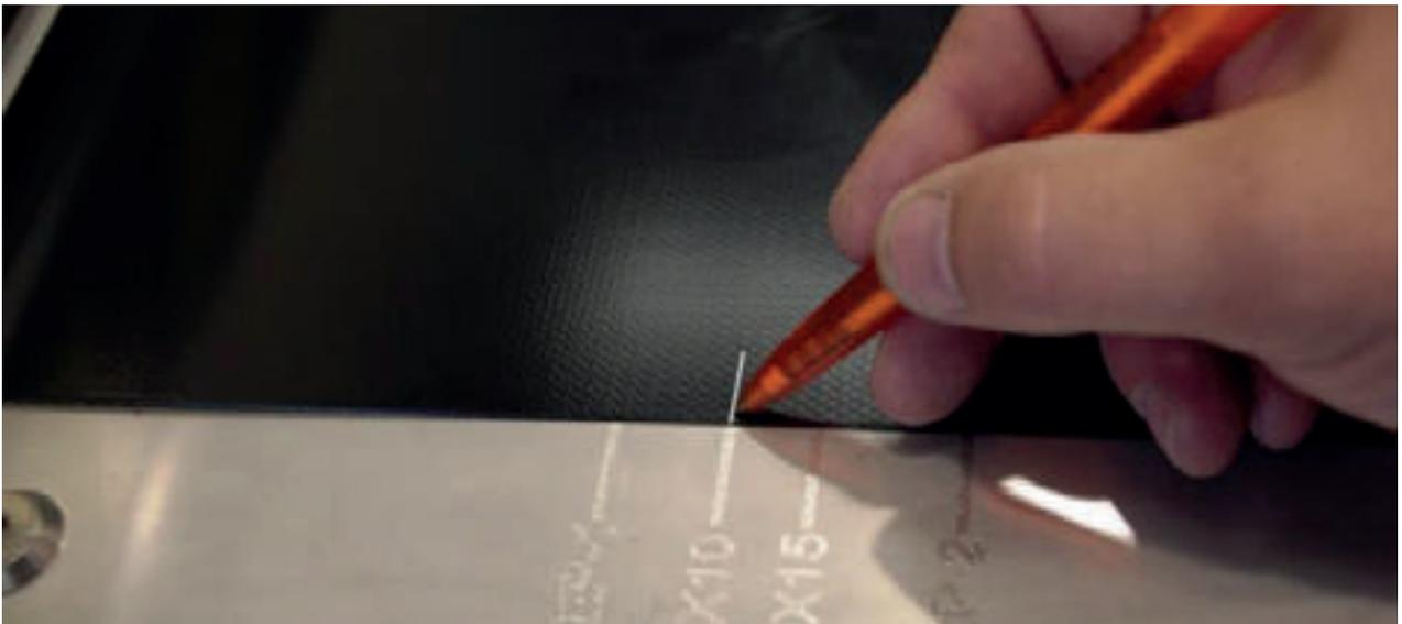
Entonces coloque la banda bajo la barra de enrollado hasta que la marca esté delante del 0 y asegúrese de que está completamente en contacto con el carril guía.
