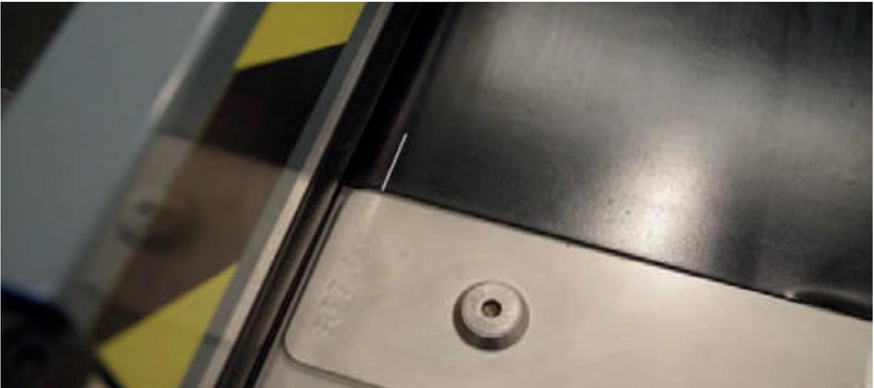
Reduzca la presión de corte a 2 bares. El segundo corte sólo cortará la tela superior. Baje la barra de enrollado y presione INICIO.
