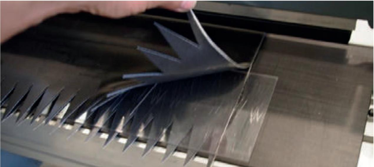
Una vez que la bandeja se haya colocado dentro, inserte el material hasta la segunda marca ETAPA-2.
