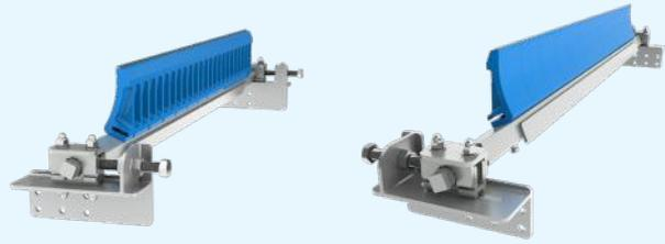
La versión pesada **RacloFlex Z<sup>2</sup>-HD** está disponible para bandas de 1400 a 2200 mm; Carburo de tungsteno 5x10, Tubo, ejes y mecánica reforzada.
