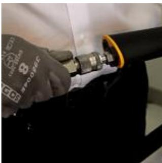
5| Conectar **MLT Quick Driver** al aire comprimido (es necesario ensamblar el punzón especial de la **Self-Lock®** y el cabezal del **MLT Quick Driver**). En el FRL (Filtración, Regulación, Lubricación), fijar la presión correspondiente a la grapa a instalar (buscar en la tabla de presiones página 3).
