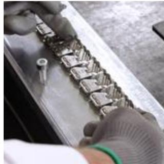
2| Elegir el peine en función del tipo de **Mini Record** y colocarlo en el útil de instalación. Colocar la grapa (grapones arriba) en el útil de instalación. Insertar el pasador.
