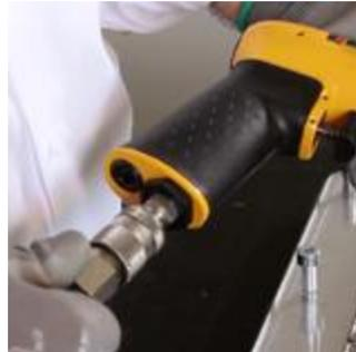
4| Conectar el **MLT Quick Driver** al compresor (necesario primero ensamblar la guía del punzón y el punzón especial de la **Mini Record** en el martillo). En el FRL (Filtración, Regulación, Lubricación) Establecer la presión correspondiente de las grapas a instalar (buscar en la tabla de presiones página 3).
