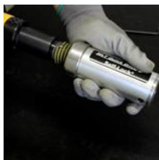
4| Insertar el cabezal correspondiente (**Self-Lock®** o **Mini Record**) en el punzón fijado previamente.
