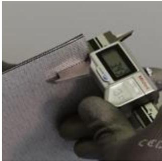
1| Selección de la grapa en función del espesor de la banda. Cortar la banda en ángulo recto.
