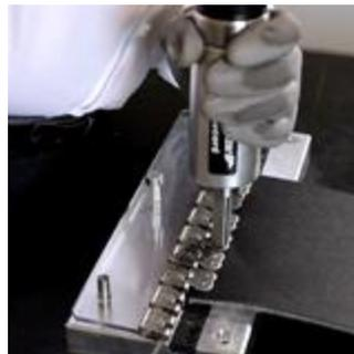
6| Posicionar el cabezal sobre los dos grapones verticalmente y presionar hacia abajo para cerrar las grapas. Pulsar el gatillo para activar el martillo (pequeñas pulsaciones son suficientes). Comenzar por los extremos izquierdo y derecho, después el centro. Los grapones se cerraran por solos cuando golpeen contra la base metálica.
