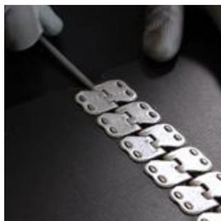
10| Cortar los laterales de la banda. Insertar los pasadores en la grapa. Si es necesario bloquearlo con arandelas en ambos lados.
