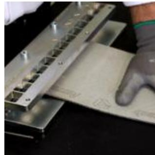
4| Colocar la cara inferior de la banda contra el peine. Sujetarla con la mano o con los tornillos de fijación.
