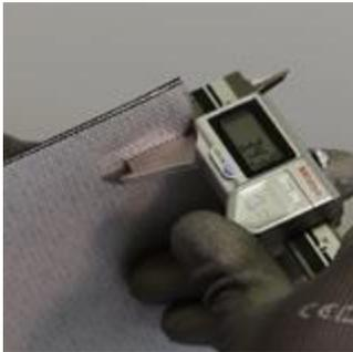
1| Verificar el espesor de la banda para elegir la grapa adecuada, Cortar la banda en ángulo recto.
