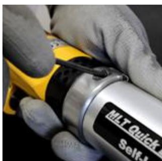
5| Girar el cabezal para un uso más confortable y apretar el anillo de la abrazadera con una llave Allen.
