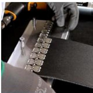
7| Colocar la placa metálica debajo de la **Mini Record** y martillar el grapón con el cabezal de acero del martillo para cerrar la **Mini Record** Repetir la operación en todas las grapas. Retirar el husillo.
