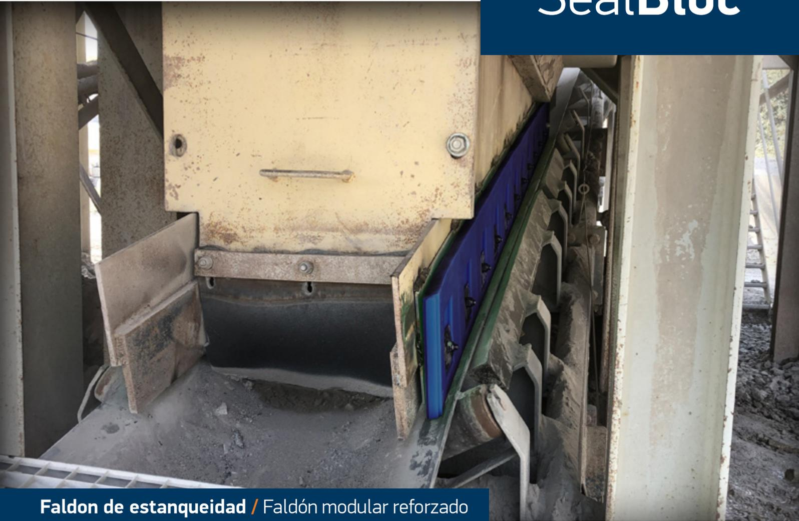
**Faldon de estanqueidad / Faldón modular reforzado** para puntos de transferencia y bordes longitudinales
