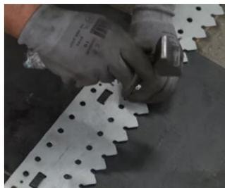
2| Alinear los dos extremos de la banda. Clavar la plantilla de perforación en diversos lugares de la banda.
