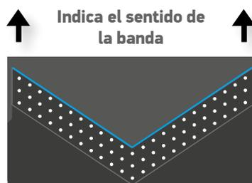
Utilizar el extremo cóncavo de la banda ISC™ para trazar la V antes de cortarla
