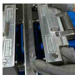
8| Colocar la superficie de cierre en los imanes. Clip'N Lock™ debe ser visible en la parte superior
