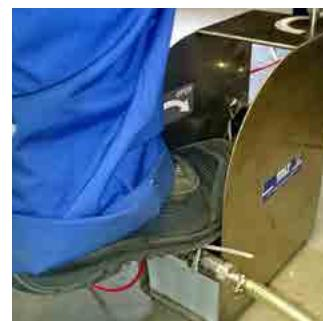
**14|** Presionar el pedal. Verificar la presión de cierre con el manómetro. Levantar el pie cuando se alcance la presión deseada (al final, la bomba emite una señal acústica). Abrir la máquina soltando el pedal.
