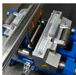
6| Colocar el ensamblaje en las muescas de la Multitool™ abierta
