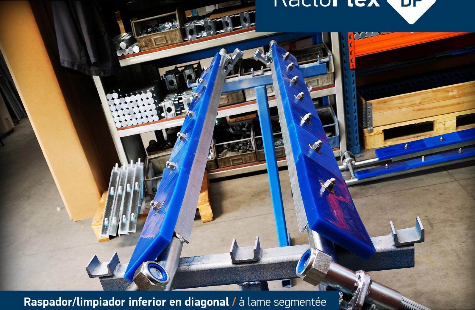
**Raspador/limpiador inferior en diagonal / à lame segmentée**
