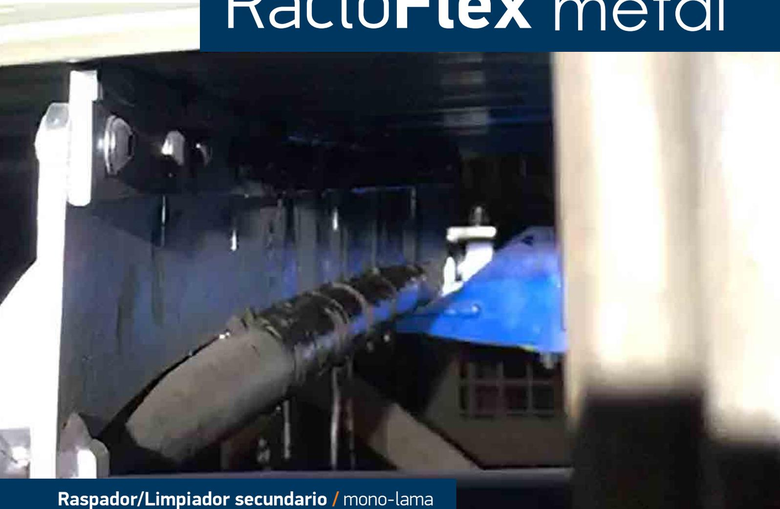
**Raspador/Limpiador secundario** / mono-lama segmentada para banda de 300 a 1200 mm
