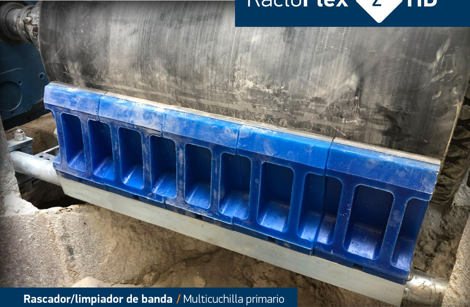
**Rascador/limpiador de banda / Multicuchilla primario**
